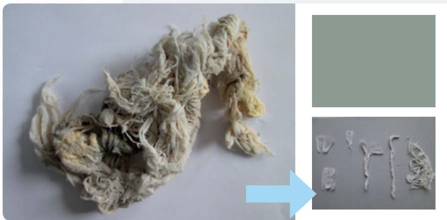
Análisis de un bloqueo real encontrado en una de las bombas de AZV Saal: La causa claramente no es por toallitas húmedas dispersadas (por ejemplo toallitas para bebés). Todas las muestras contenían poliéster y fibras de viscosa larga y se fabricaban en procesos típicos de hilatura (para alta resistencia) | Analysis of a real blockage found in one of the pumps of AZV Saal: The cause is clearly not dispersed wet wipes (e.g. baby wipes). All samples contained polyester and long viscose fibres and were manufactured in typical spunlace processes (for high strength).
