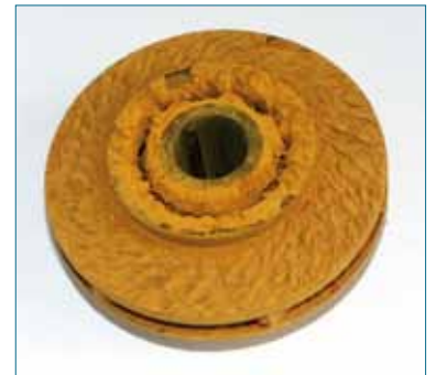
Abb. 6: Die Ablagerung von Eisenmanganoxid ist einer der Hauptfaktoren für unterdurchschnittliche Wirkungsgrade und Förderraten bei Brunnenpumpen. Besonders sind davon Laufräder und Leitgehäuse betroffen, wodurch hydraulische und volumetrische Leistungseinbußen auftreten.
