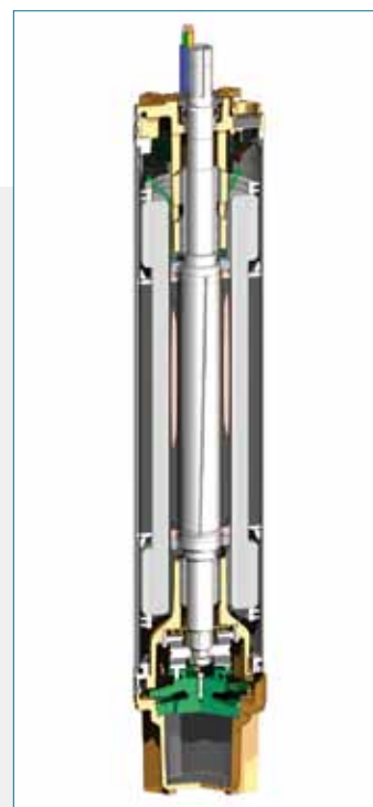
Abb. 10: Bei „CoolAct“-Motoren mit aktiver, interner Umlaufkühlung kann die Abwärme aus der Wicklung des Motors optimal aufgenommen und über den Außenmantel an das umströmende Medium abgegeben werden. Dadurch werden Leistungssteigerungen um bis zu 25% bei gleichzeitig reduzierter Motorbetriebstemperatur erzielt.
