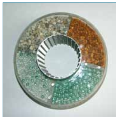
Abb. 5: Modell eines Brunnens mit Wickeldrahtfilter und unterschiedlichen Ringraumverfüllungen. Das Modell zeigt deutlich, dass durch Glaskugelschüttungen eine einheitliche Körnung, absolut glatte Oberflächen und gleichmäßige Porenzwischenräume erreicht werden. Eine Verstopfung der Filterschlitzte durch Unterkorn ist hierbei nicht möglich.
