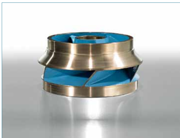
Abb. 7: Die innovative „Ceram CT“-Beschichtung mit KTW-Zulassung wurde zum Schutz vor Ablagerungen von Pumpen in der Wasserversorgung entwickelt. Sie wird auf die medienberührten Bereiche von Laufrädern und Leitgehäusen aufgetragen. Durch die geringe Oberflächenrauigkeit wird zudem eine Steigerung des Pumpenwirkungsgrades um 2% erzielt.
