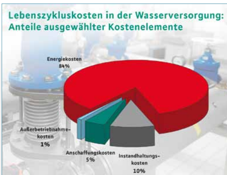
Abb. 9: Die Lebenszykluskosten einer Pumpe für die Wasserversorgung zeigen, dass die Energiekosten mit 84% den größten Posten darstellen. Der Anteil der Anschaffungskosten fällt demgegenüber mit 5% vergleichsweise gering aus. Bei Neuanschaffung oder Ersatzbeschaffung von Pumpen empfiehlt es sich daher, immer die Gesamtwirtschaftlichkeit der Pumpe im Blick zu haben.
