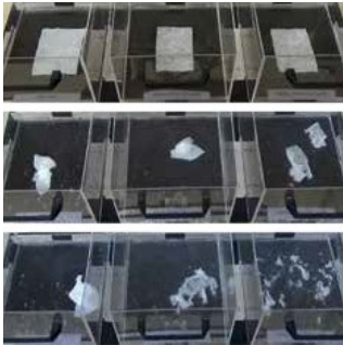
Bild 3 Die Tücher mit VILOFT-Fasern sind nach 30 Minuten sichtbar aufgelöst. Quelle: Kelheim Fibres
