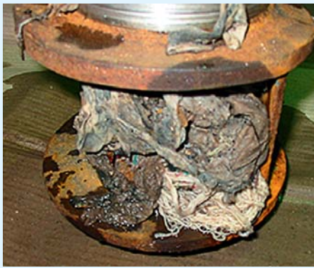
TYPISCHE SCHADENSBIlder: Verzopfungen im Laufrad (links) und im Radseitenraum
