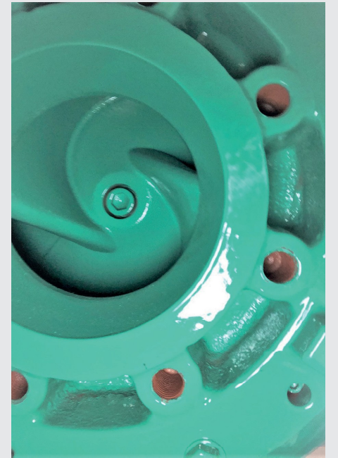
Bild 7 Vom Saugstutzen in die Pumpe geschaut. Quelle: Wilo
