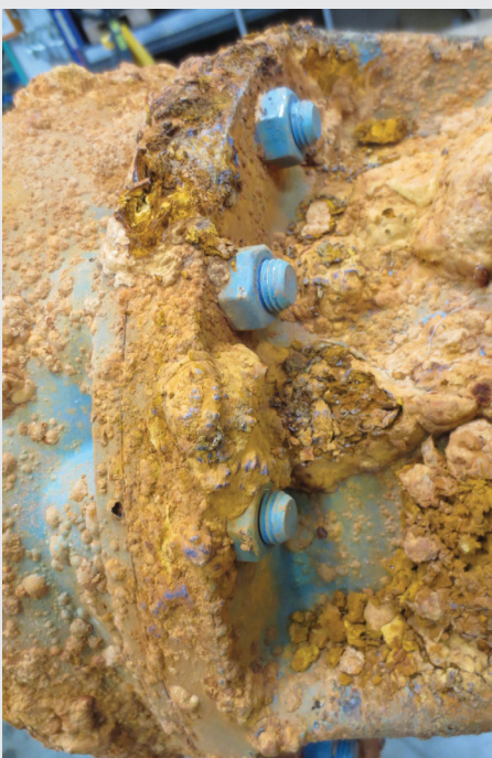
Bild 5 Pumpe vor der Generalüberholung Quelle: WILO SE
