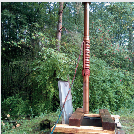
Bild 3 und 4 Wilo-Actun ZETOS-K.100-5 mit starken Verockerungen nach sieben Jahren Dauerbetrieb
